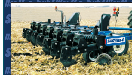
Глубокорыхлители SubTiller 4 навесные 3-точечные, прицепные и складные • обеспечивают дробление уплотненного грунта
