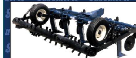
Прикатывающий каток в качестве опции минимизирует риск эрозии. Он вдавливает поверхностный остаток в грунт позади SubTiller II. Регулировка заглубления и давления на грунт не представляет труда благодаря реечным домкратам.
