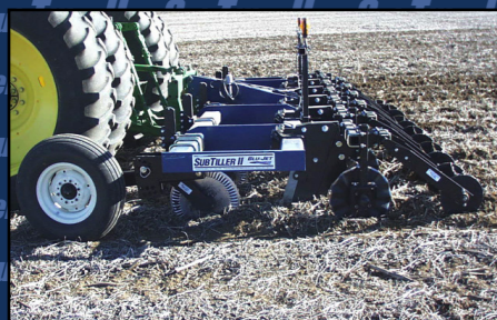
Опция StripTill для полосной почвообработки крепится на стойки со срезным болтом
